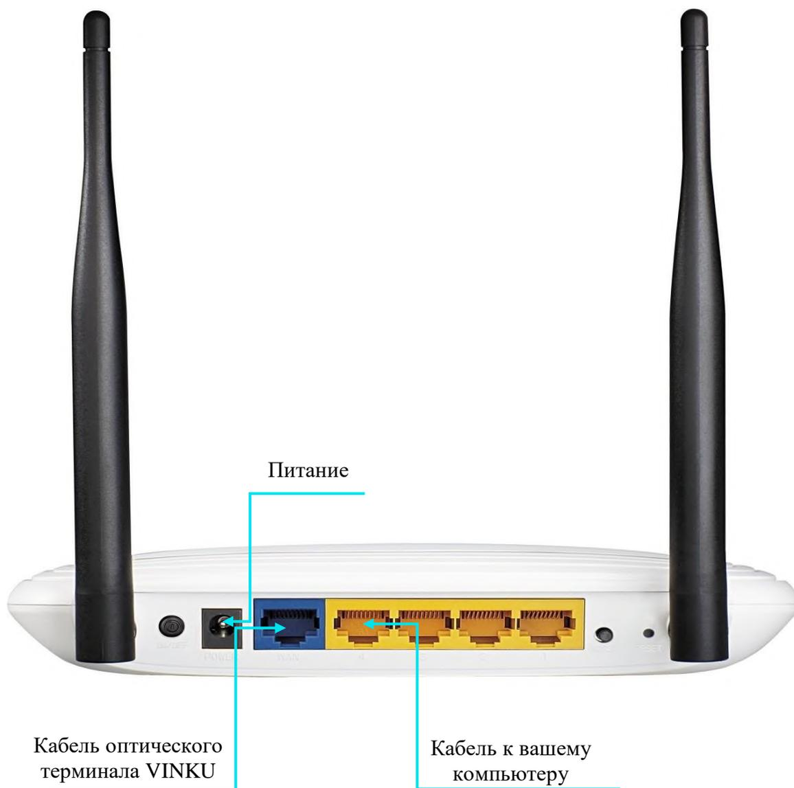
1.1 Подключите кабель от оптического терминала VINKU в разъем синего цвета, обозначенный надписью «**Интернет**».
